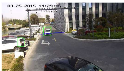
Cruce de Línea
